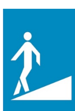
(Π - 63) Ανισόπεδη διάβαση πεζών χωρίς σκαλοπάτια
