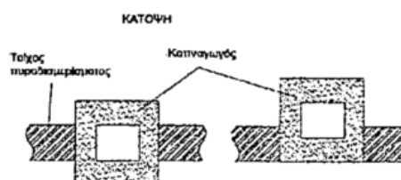
Σχήμα 21: Τυπική διάταξη πυράντοχων διαφραγμάτων (damper)
