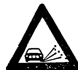
(K - 13) Επικίνδυνη εκτίναξη χαλίκων, (ασύνδετο αμμοχάλικο).
