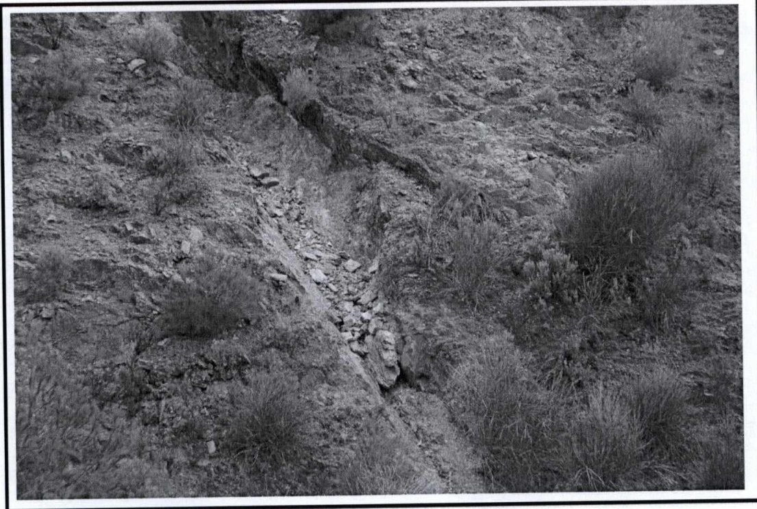
Φωτογραφία 18 Εφελκυστική διάρρηξη (κοντινό πλάνο) που συνδέεται με την ζώνη χαμηλών αντιστάσεων στη θέση 48 της τομογραφίας LR_1
