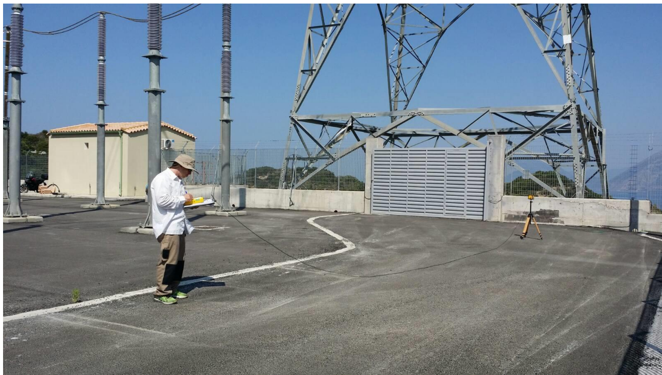
Εικόνα 2: Φωτογραφία κατά τη διάρκεια διεξαγωγής μέτρησης της έντασης του ηλεκτρικού πεδίου της Τερματική Διάταξης Καστριτσίου.
