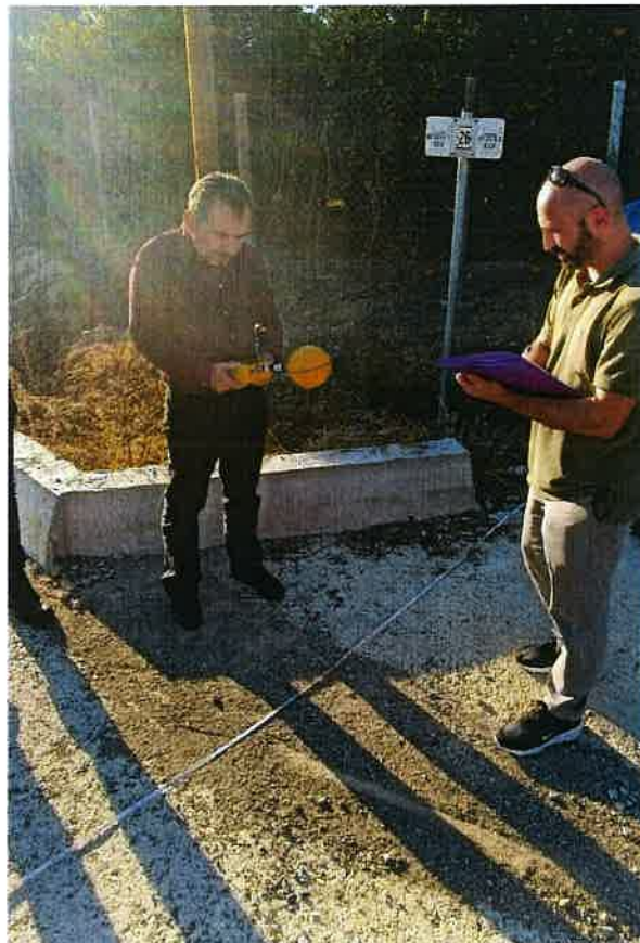
Εικόνα 4: Φωτογραφία κατά τη διάρκεια διεξαγωγής μέτρησης του μαγνητικού πεδίου στην πινακίδα (26) ένδειξης θέσης καλωδίων (Θέση 3).
