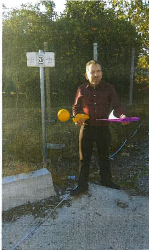
Εικόνα 3: Φωτογραφία κατά τη διάρκεια διεξαγωγής μέτρησης του μαγνητικού πεδίου στην πινακίδα (26) ένδειξης θέσης καλωδίων (Θέση 3).
