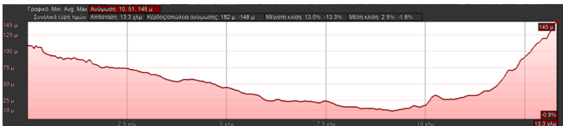
Εικόνα 9-2 Μηκοτομή εξεταζόμενης όδευσης αγωγού διυλιστηρίου φράγματος Φανερωμένης
