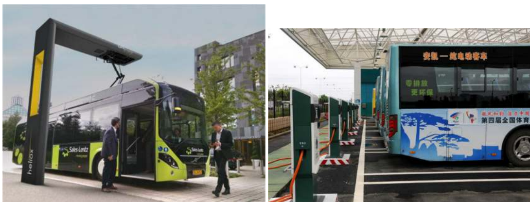
Σχήμα 4-3: Φόρτιση λεωφορείων με παντογράφο επί της οδού και σε αμαξοστάσιο
