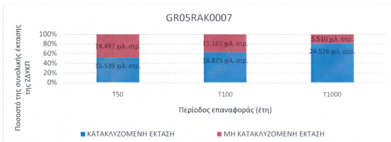
Γράφημα 2 Κατακλυζόμενες εκτάσεις στη GR05RAK0007 για τις πλημμύρες περιόδου επαναφοράς 50, 100 και 1 000 ετών
